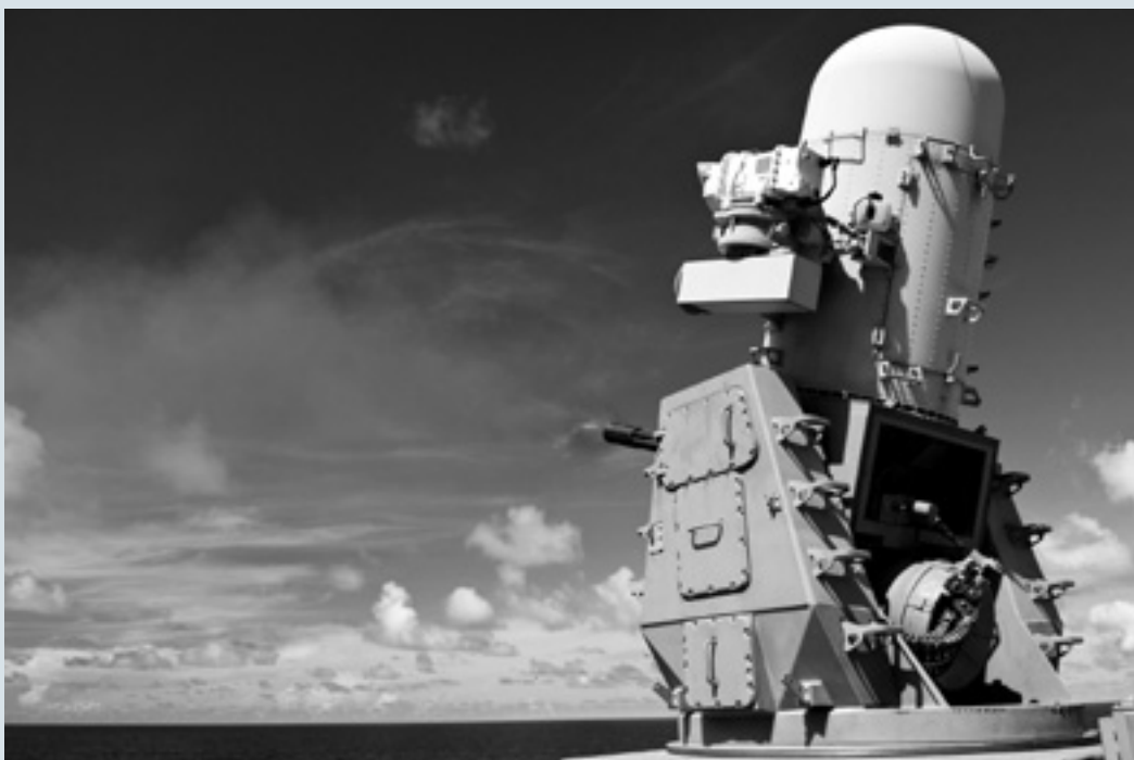
Een Phalanx Close-In Weapons System aan boord van een Amerikaanse Cruiser. Het wapensysteem kan automatisch inkomende raketten detecteren en vernietigen. Foto Official U.S. Navy Page
